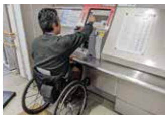
三菱商事太陽がある亀川駅の券売機。タッチパネルが低い位置に。
